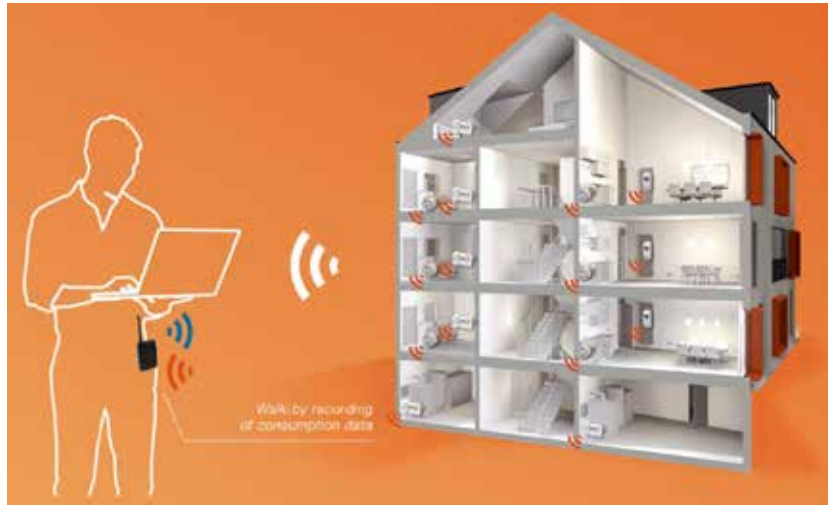
Figura 7-16 – Esquema de uma solução de rádio móvel ( “walk by” )
