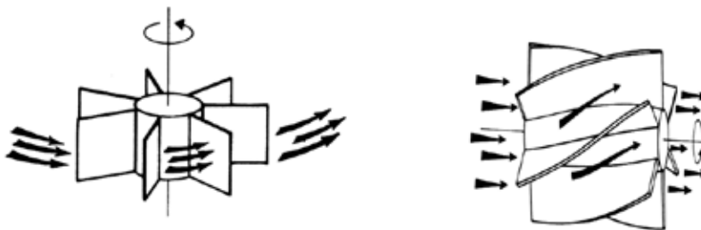
Figura 5-28 – À esquerda, uma turbina de pás planas (molinete); à direita, uma turbina helicoidal, que equipa os contadores do tipo “woltmann”
