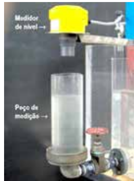
Figura 5-57 – Modelo didático, transparente, que mostra como funciona o poço de medição
