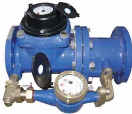
Figura 5-36 – Contador conjugado, de modelo antigo, constituído por um contador principal “woltmann”, um contador secundário multijacto (ambos “normais”), associados a uma válvula comutadora
