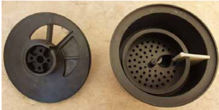
Figura 5-12 – Câmara volumétrica de êmbolo oscilante (tampa e êmbolo colocado na câmara)
