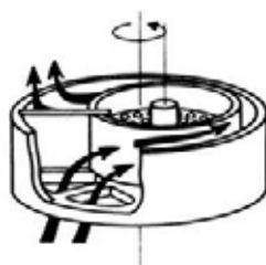
Figura 5-10 – Representação esquemática do funcionamento de uma câmara volumétrica de êmbolo oscilante
