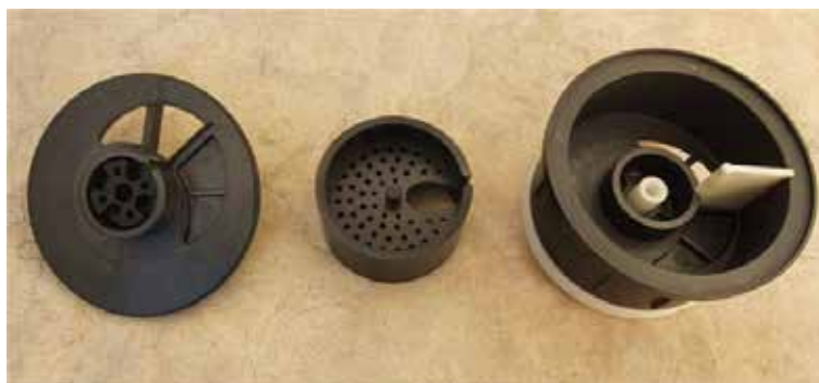
Figura 5-11 – Câmara volumétrica de êmbolo oscilante (tampa, êmbolo e câmara)
