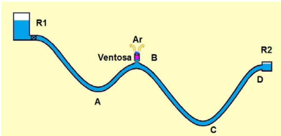
Figura 4-29f – Sistema adutor gravítico - particularidades do escoamento
