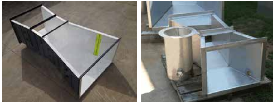
Figura 5-63 – Caleiras “Parshall” pré-fabricadas para montagem no local. Na da direita observa-se o poço de medição acoplado
