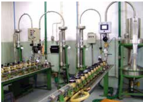
Figura 3-17 – Bancos de ensaio para contadores de água residenciais; ao fundo, vêem-se diversos padrões de volume de diferentes capacidades 7
