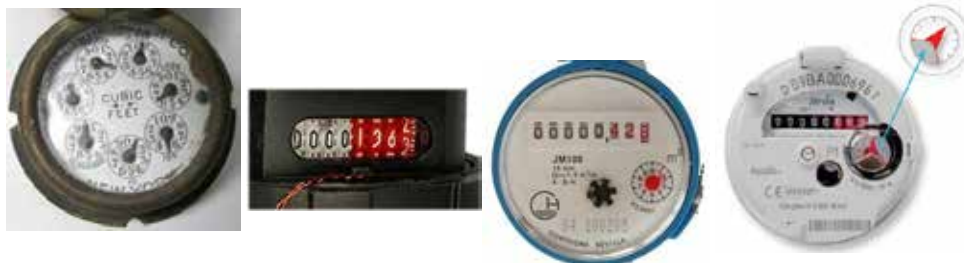
Figura 5-40 – Diversos tipos de mostrador: Só ponteiros; só rolos; mistos de rolos e ponteiros
