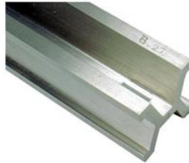
Figura 3-10 – A barra de platina-irídio utilizada no protótipo do metro (1889 – 1960)
