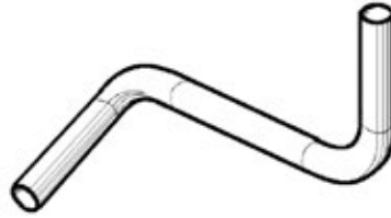
Figura 6-3 – Curva e contracurva em planos diferentes induzem rotação no escoamento
