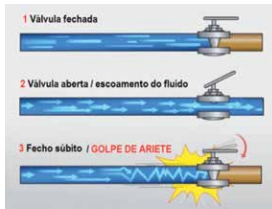
Figura 4-21 – Representação esquemática da formação de um golpe de ariete
