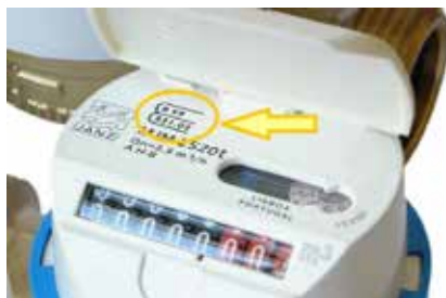
Marca de aprovação de modelo CEE num contador de água
