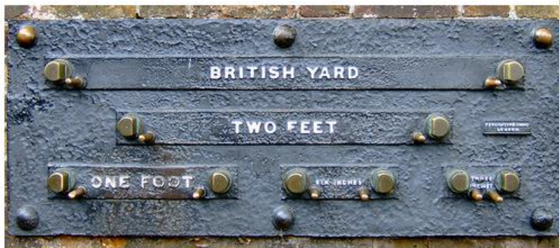
Figura 3-4 – Quadro público, afixado numa parede, com referenciais de medidas Inglesas (British yard – two feet – one foot – six inches – three inches)
