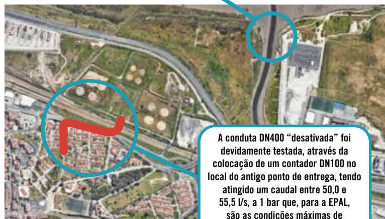
Abastecimento a Loures, através da conduta DN160, instalada por baixo da ponte pedonal. Caudal acordado com Loures para a Ponte Pedonal: 56 m 3 /h
