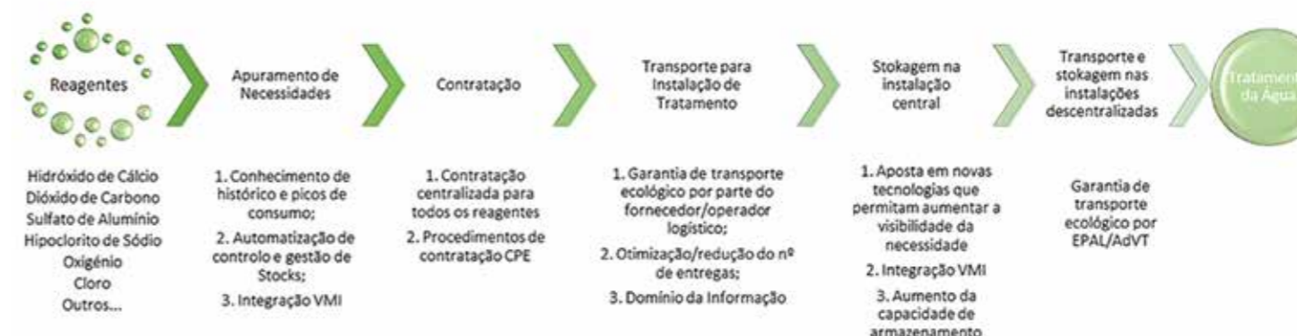
Proposta de Otimização das diferentes fases da Cadeia de Abastecimento de Reagentes de Tratamento de Água na EPAL e na AdVT
