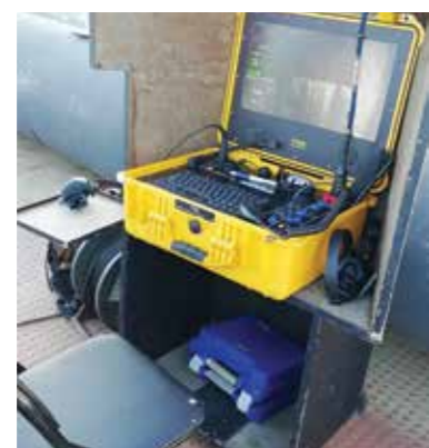
Registo de vídeo em circuito fechado com visualização através de monitor à superfície; verificação da condição física da grade de proteção da entrada de água à cota 192,50 m e do pilar
